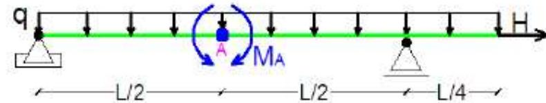
A continuación se indica el **mecanismo de un grado de libertad** al que se le aplica el **desplazamiento virtual (DV)**:
