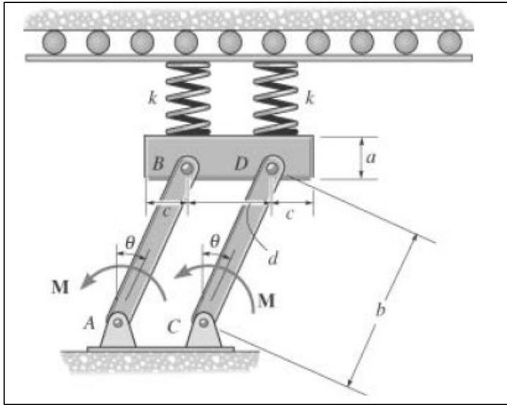
Problema 12: Cuando  $\theta = \theta_0$ , el bloque  $W_b$  comprime los dos resortes con un desplazamiento  $\delta$ . Si las bielas  $AB$  y  $CD$  pesan cada una  $W_L$ , determine la magnitud de  $M$  a aplicar para mantener el equilibrio.
