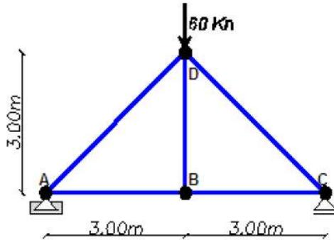
Si se pretende determinar por aplicación del principio de los trabajos virtuales el esfuerzo en la barra **BC** entonces el sistema equilibrado (**SE**) es el que se indica a continuación:
