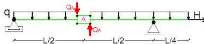
A continuación se indica el **mecanismo de un grado de libertad** al que se le aplica el **desplazamiento virtual (DV)**:
