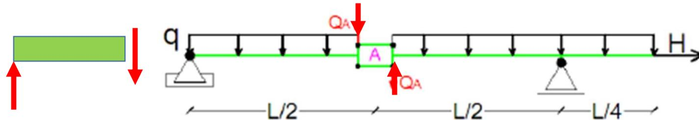
A continuación se indica el mecanismo de un grado de libertad al que se le aplica el desplazamiento virtual (DV):
