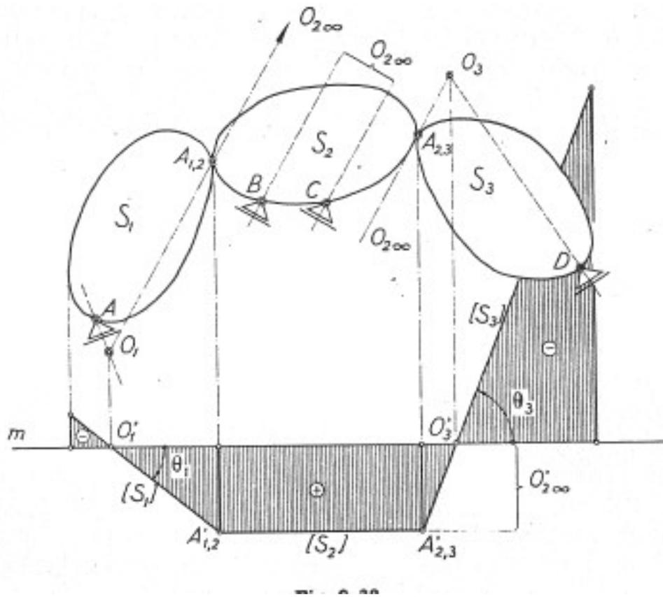
Cuando una chapa tiene dos apoyos moviles paralelos, por las articulacion con las demas chapas Se llevan paralelas a la direccion del impropio. Impropio de la A1,2 y Apoyo Movil A establecen O1. Impropio de la A2,3 y apoyo movil D establecen O3 La chapa S2 tiene su polo en el impropio
