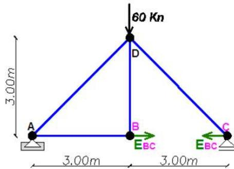
A continuación se indica el mecanismo de un grado de libertad al que se le aplica el desplazamiento virtual (DV):
