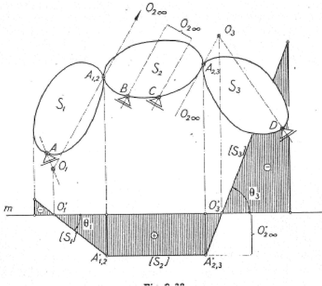
Quando una chapa tiene dos apoyos moviles paralelos, por las articulacion con las demas chapas Se llevan paralelas a la direccion del impropio. Impropio de la  $A_{1,2}$  y Apoyo Movil A establecen  $O_1$ . Impropio de la  $A_{2,3}$  y apoyo movil D establecen  $O_3$  La chapa  $S_2$  tiene su polo en el impropio
