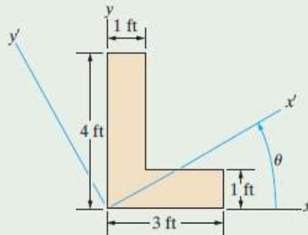
$$I_{x'} = \frac{I_x + I_y}{2} + \frac{I_x - I_y}{2} \cos 2\theta - I_{xy} \sin 2\theta$$
