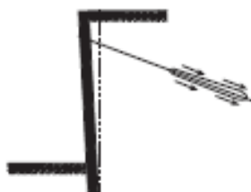
■ (b) FALLA DE LA INTERFASE TERRENO-BULBO
