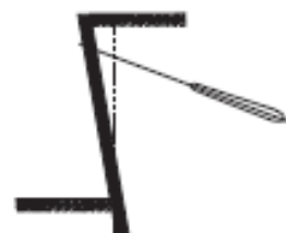
■ (c) FALLA DE LA INTERFASE LECHADA-TENDON
