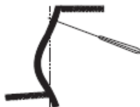
■ (e) FALLA DEL MURO POR FLEXION Y CORTE
