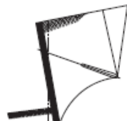
■ (h) FALLA POR LA CUÑA PROFUNDA (ROTACION)
