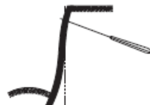
■ (f) FALLA DEL MURO POR FICHA INSUFICIENTE
