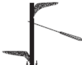
■ (g) FALLA DEL MURO POR HUNDIMIENTO
