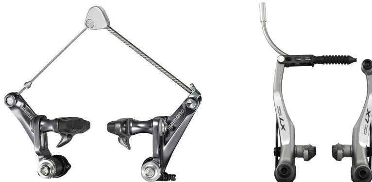
mecánica de bicicletas: frenos cantilever c/tiro central [izq.] y V-BRAKE (más efectivos) [der]
