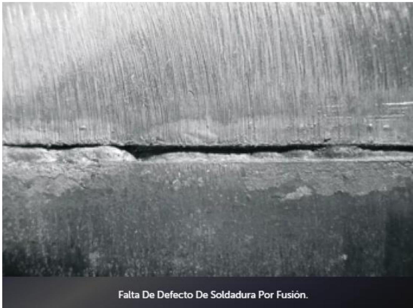
Falta De Defecto De Soldadura Por Fusión.
