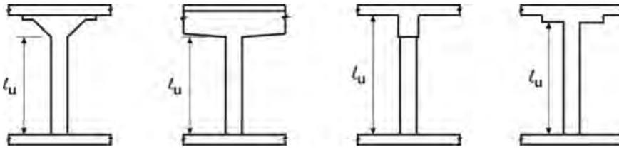
Distancia libre entre losas de entrepiso, vigas u otros elementos capaces de proporcionarle apoyo lateral en la dirección considerada.
