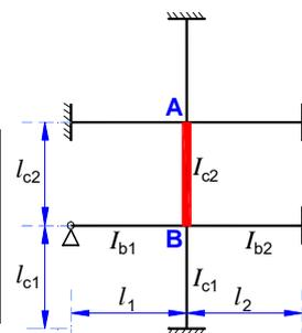
Longitud efectiva  $l_e$  en columnas de **Sistemas Indesplazables**
