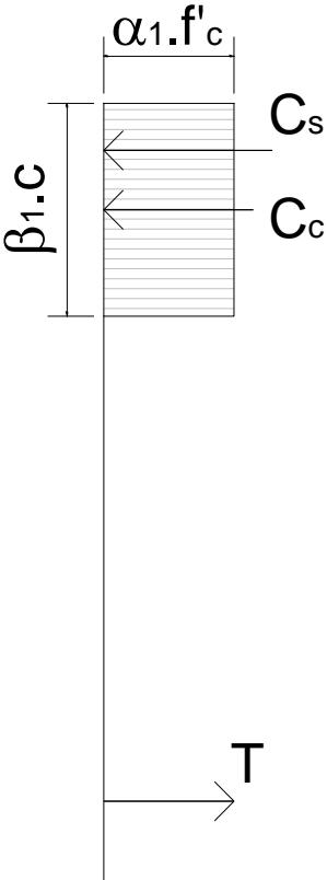
Calculamos la fuerza en la armadura comprimida:
