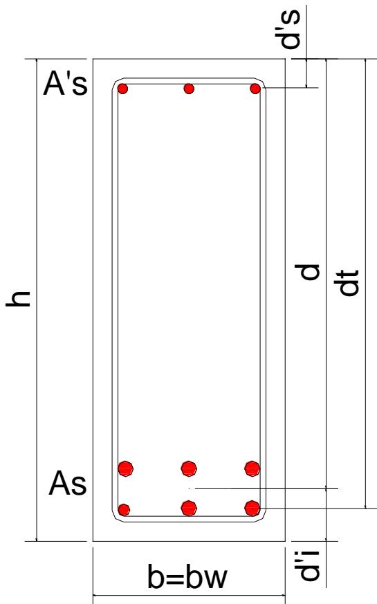
Se pide determinar la armadura necesaria para la siguiente rectangular sometida a un esfuerzo de flexión con esfuerzo axil.
