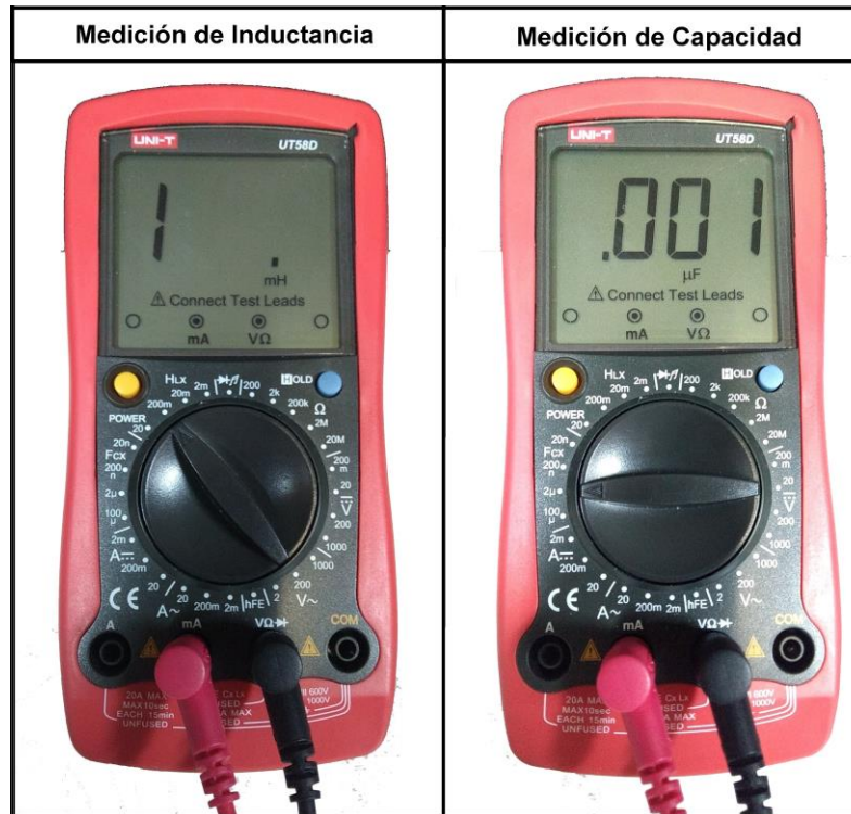
Figura 3: Diagrama de conexión del multímetro Uni-T UT58D, para la medición de inductancia o capacidad .
