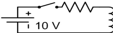
7. El gráfico muestra la corriente,  $I(t)$ , que circula por una inductancia  $L = 10$  H alimentada por una pila  $V_0$  a través de una resistencia  $R$ . El punto del gráfico que se indica con línea punteada corresponde al instante ( $t$ ) en el que  $I(t) = 0.63 \times I(t = \infty)$ . Calcular el valor de la pila que alimenta el circuito y de la resistencia.
