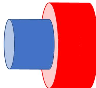
3. Los bloques conductores de la figura tienen dimensiones  $a = 10$  mm,  $b = 20$  mm,  $c = 30$  mm,  $h = 50$  mm. El bloque azul tiene conductividad  $\sigma_1 = 2 \times 10^{-8} \Omega^{-1} \text{m}^{-1}$  y el rojo  $\sigma_2 = 4 \times 10^{-8} \Omega^{-1} \text{m}^{-1}$ . Toda la base del conjunto se encuentra a un potencial  $V_1 = 10$  V y la tapa superior a  $V_2 = 20$  V. Calcular la corriente que circula por todo el conjunto.
