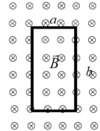
2. El cuadro de la figura de 5 cm de lado, que se mueve a una velocidad uniforme de 3 m/s, penetra en una región de 20 cm de lado donde hay un campo  $\vec{B}$ , uniforme y normal a la dirección del movimiento, de intensidad  $B = 0.2$  T. Si el cuadro está formado por 50 espiras, determinar y graficar el valor de la f.e.m. inducida sobre él en función de su posición. Si el cuadro es de un material conductor, determinar el valor y el sentido de la corriente inducida.
