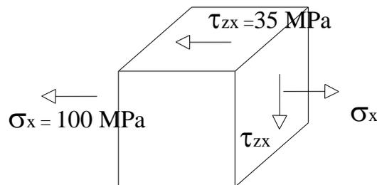
El material de la barra presenta en un ensayo a tracción una tensión de rotura  **$\sigma_R = 150$  MPA** y en torsión  **$\tau_R = 75$  MPA**
