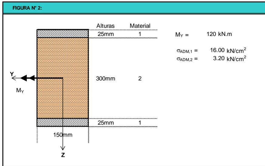
**EJERCICIO N° 3:** Para el esquema estructural de la figura, las características geométricas de la sección transversal y las características mecánicas del material, se pide:
