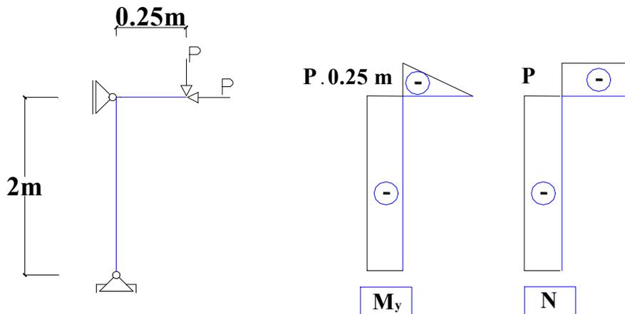
b.- Determinar el valor de la fuerza exterior **P** última que pueda aplicarse sobre la estructura
