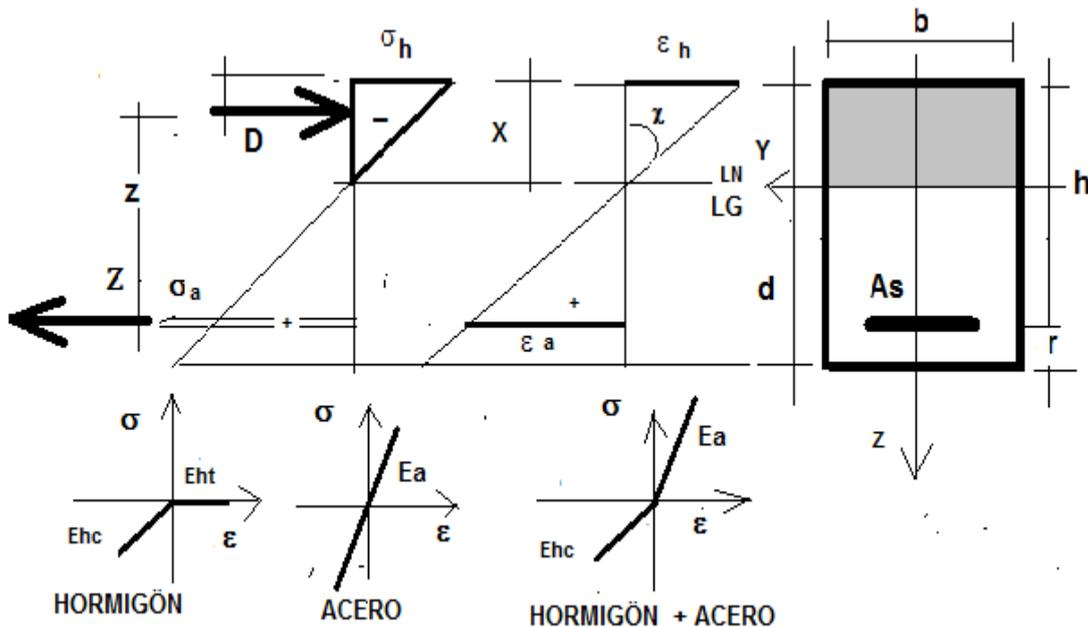
De las ecuaciones de equivalencia obtenemos la ubicación de la Línea Neutra y la expresión de cálculo del momento admisible para la falla del H° o del A° en Periodo Elástico a partir de los valores de resistencia de ambos materiales-
