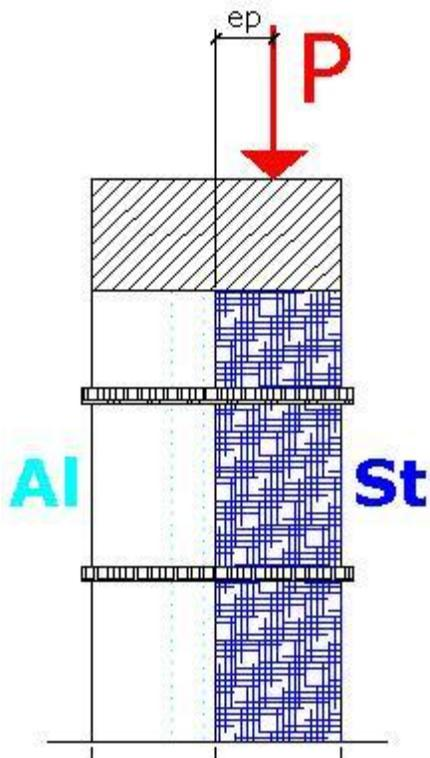
Para las barras de la figura y suponiendo el cabezal superior infinitamente rigido, calcular la excentricidad que debera tener la carga P para que el cabezal se desplace en forma horizontal.
