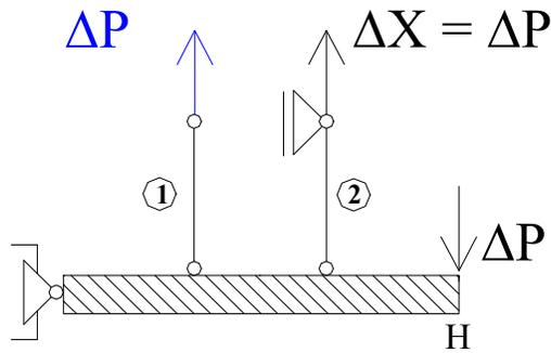
Determinamos el máximo P, que se alcanzará cuando la barra trabaje con tensión igual a 150 MPa
