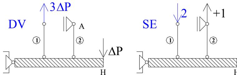
Determinamos  $(\eta_{A, \Delta X})^0$  por aplicación TTV
