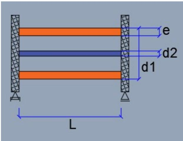
Una vez salvado el error de montaje, hay que sacar la temperatura aplicada  $\Delta T$ . Para lograrlo, aplicamos a la barra una temperatura igual y de signo contrario a  $\Delta T$ . La barra 1 queda cargada con:
