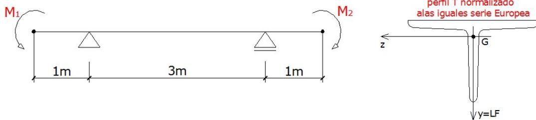
**EJERCICIO N° 13:** Una viga de sección I se encuentra sometida a un momento flexor  $M_y$ . Calcular las platabandas que deben colocarse simétricamente arriba y abajo del perfil para las condiciones de resistencia que se indican.
