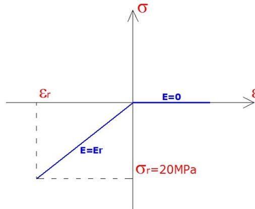
**EJERCICIO N° 17:** Calcular la carga por  $\text{m}^2$  que soporta una losa de hormigón armado, con una armadura de  $5 \phi 10 \text{ mm}$  c/m, considerando que el hormigón no trabaja a la tracción. Trazar los diagramas de  $\sigma$  y  $\epsilon$  de la sección analizada.
