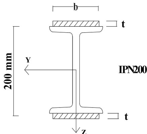
**EJERCICIO N° 14:** Determinar los valores máximos de la fuerza P que satisfacen, para el esquema de la figura, las condiciones de resistencia indicadas en todos los puntos de las secciones normales al eje de la barra. Se solicita que se indiquen para las secciones que se analicen los diagramas de tensiones normales. Representar en una circunferencia de Mohr, el estado de deformación que se genera en el punto B de la sección sobre uno de los apoyos.
