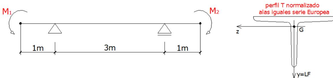
**EJERCICIO N° 13:** Una viga de sección I se encuentra sometida a un momento flexor  $M_y$ . Calcular las platabandas que deben colocarse simétricamente arriba y abajo del perfil para las condiciones de resistencia que se indican.
