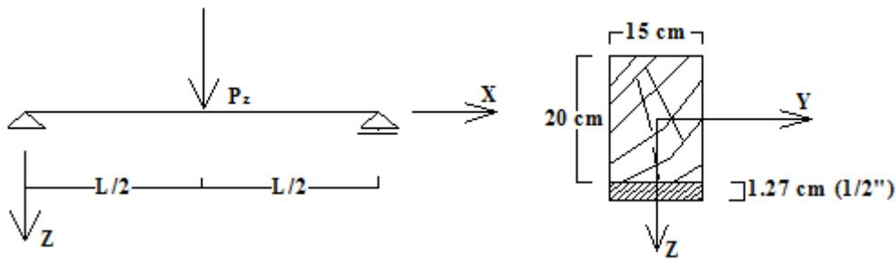
**EJERCICIO N° 10:** Calcular el máximo momento flexor admisible para un momento positivo (tracción del lado del acero).
