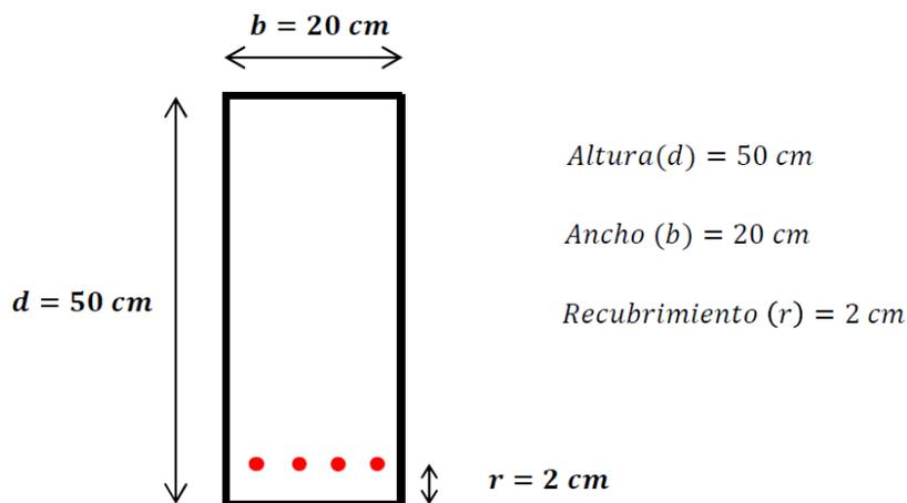
*Armadura (barras de acero) = 4 $\phi$ 16*
