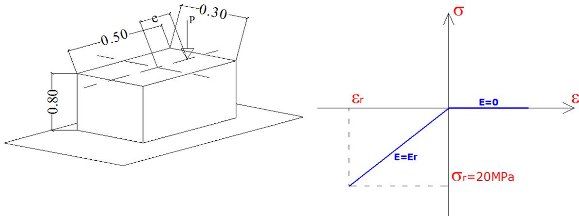
**EJERCICIO N° 17:** Calcular la carga por  $\text{m}^2$  que soporta una losa de hormigón armado, con una armadura de  $5 \phi 10 \text{ mm c/m}$ , considerando que el hormigón no trabaja a la tracción. Trazar los diagramas de  $\sigma$  y  $\epsilon$  de la sección analizada.
