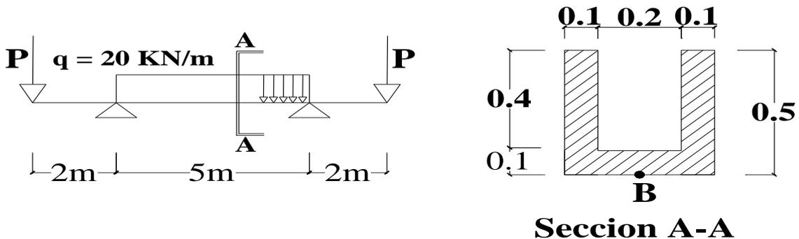
**EJERCICIO N° 15:** Para la estructura que se esquematiza a continuación, se pide:
