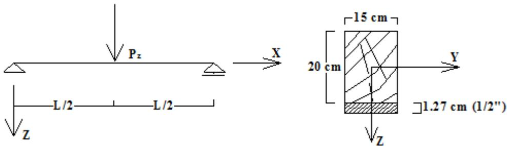
**EJERCICIO N° 10:** Calcular la carga por  $m^2$  que soporta una losa de hormigón armado, con una armadura de  $5 \phi 10 \text{ mm}$  c/m, considerando que el hormigón no trabaja a la tracción. Trazar los diagramas de  $\sigma$  y  $\epsilon$  de la sección analizada.
