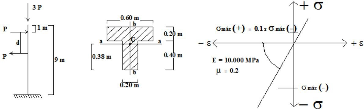
**EJERCICIO N° 16:** Determinar la máxima carga P que puede aplicarse en la estructura cuyo modelo se indica en la figura.
