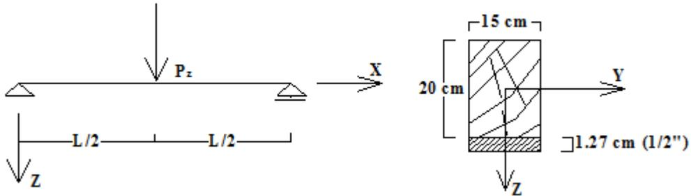
**EJERCICIO N° 10:** Calcular la carga por m<sup>2</sup> que soporta una losa de hormigón armado, con una armadura de 5  $\phi$  10 mm c/m, considerando que el hormigón no trabaja a la tracción. Trazar los diagramas de  $\sigma$  y  $\epsilon$  de la sección analizada.
