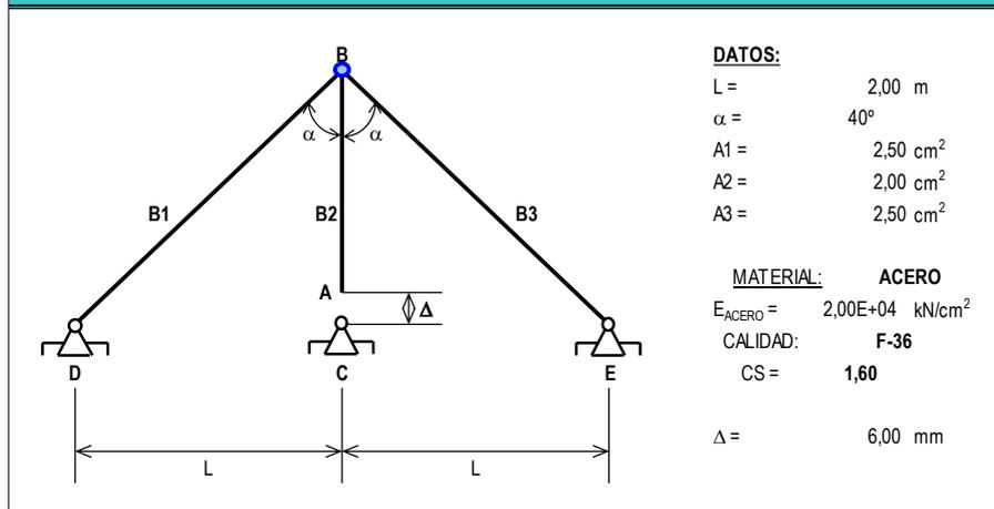
**EJERCICIO N° 19:** Para los esquemas estructurales de las Figuras N° 19.01 y 19.02, las cuales evidencian un error de montaje, se pide:
