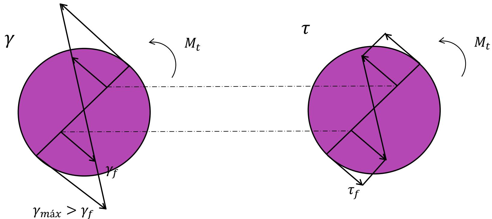
Cuando realizo la carga, las tensiones  $\tau$  **NUNCA** pueden ser mayores a la tensión de fluencia y ese valor se alcanza en todo punto donde  $\gamma \geq \gamma_f$ . Los puntos que no alcanzaron la deformación de fluencia siguen comportándose linealmente.
