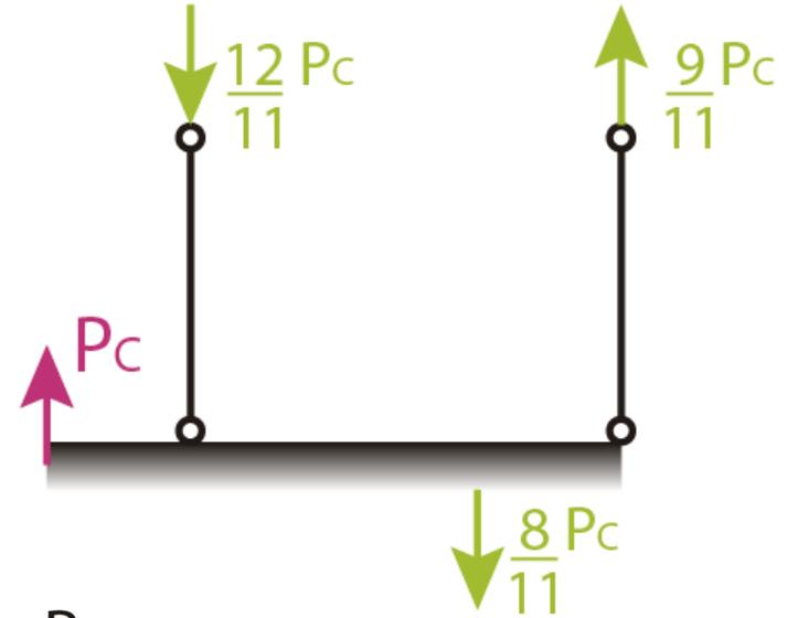
$$\frac{\delta_{A_{descarga}}}{3L} = \frac{\delta_{B_{descarga}}}{2L}$$
