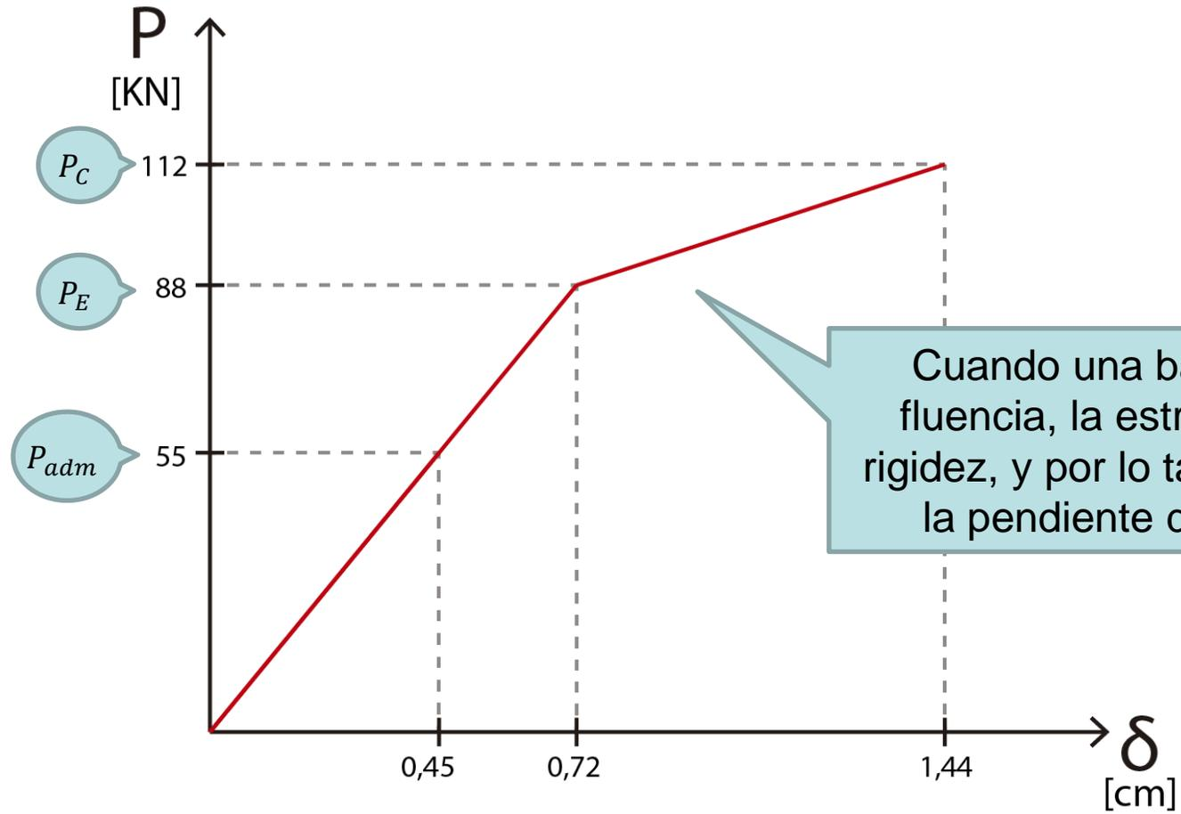
Cuando una barra entra en fluencia, la estructura pierde rigidez, y por lo tanto, disminuye la pendiente del diagrama
