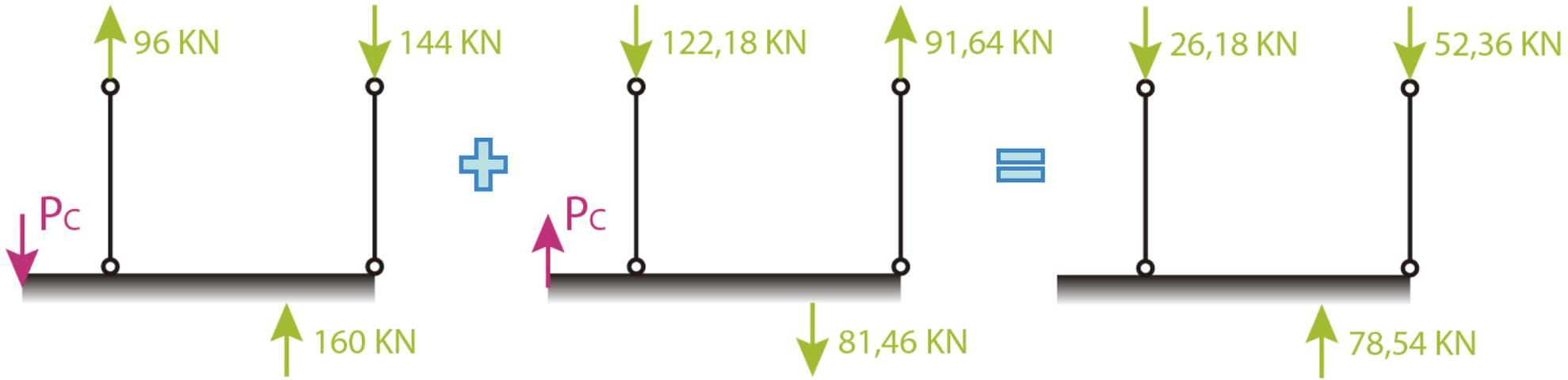
Calculamos las tensiones y el desplazamiento residuales:
