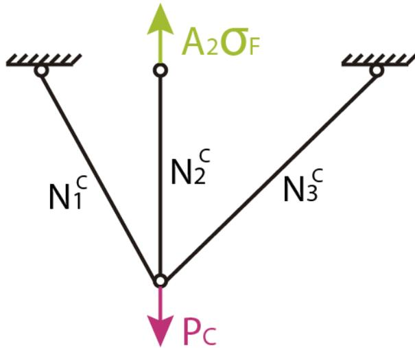
**Opción 1)** Reemplazar la barra que entró en fluencia por una fuerza de valor  $A_2 \cdot \sigma_F$  y resolver el isostático.
