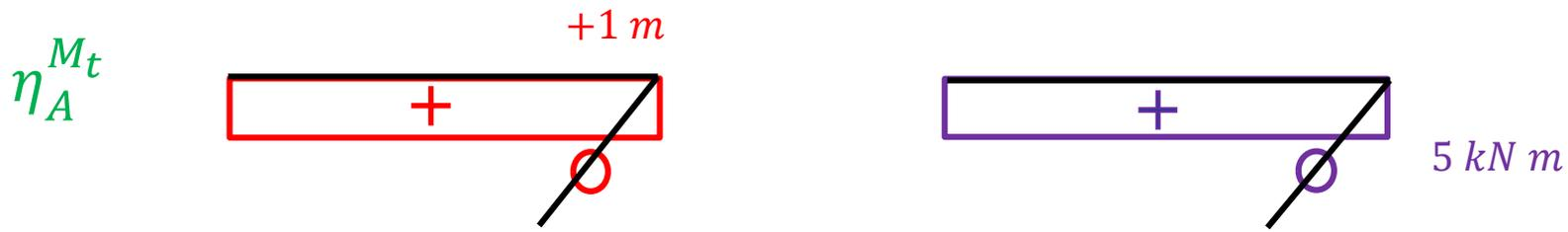
$$\int_L M_{t_{se}} \cdot \frac{M_{t_{dv}}}{G \cdot J_t} dx = 1 \cdot (+1 m) \cdot \frac{(+5 kN m)}{G \cdot J_t} \cdot 4 m$$
