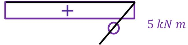
$$\int_L M_{t_{se}} \cdot \frac{M_{t_{dv}}}{G \cdot J_t} dx = 1 \cdot (+1 m) \cdot \frac{(+5 \text{ kN m})}{G \cdot J_t} \cdot 4 m$$
