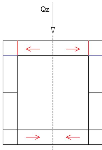
Como la sección es simétrica respecto a la línea de fuerza de corte, la distribución del flujo de tensiones de corte deberá ser simétrico.
