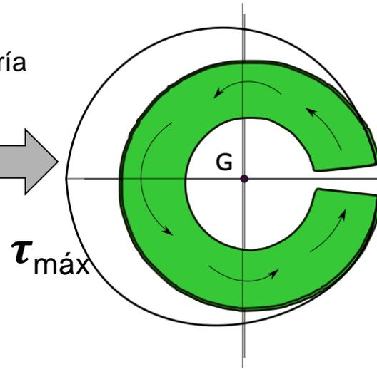
Aquí se ve que si integramos las tensiones tangenciales, la ecuación de equivalencia del Momento torsor no se cumple. Entonces debemos añadir las tensiones de torsión.
