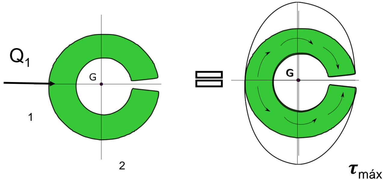
Como el corte est\u00e1 en direcci\u00f3n de un eje de simetr\u00eda pasa por el centro de corte y por lo tanto no se generan tensiones debidas a la torsi\u00f3n
