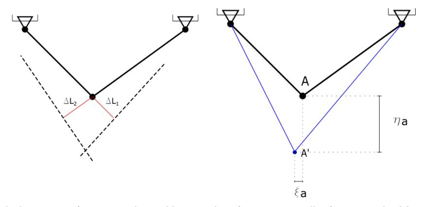
Cada barra se alarga un cierto ΔL y se desplaza perpendicular a su eje. Ya que gira entorno a un punto fijo y es válida la hipótesis de pequeños desplazamientos.
