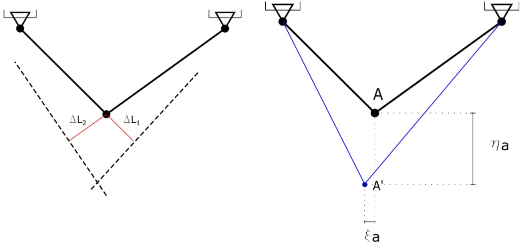
Cada barra se alarga un cierto  $\Delta L$  y se desplaza perpendicular a su eje. Ya que gira entorno a un punto fijo y es válida la hipótesis de pequeños desplazamientos.
