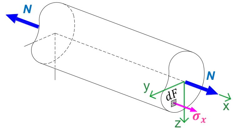
Secciones planas y paralelas permanecen planas y paralelas  $\varepsilon_x = cte$
