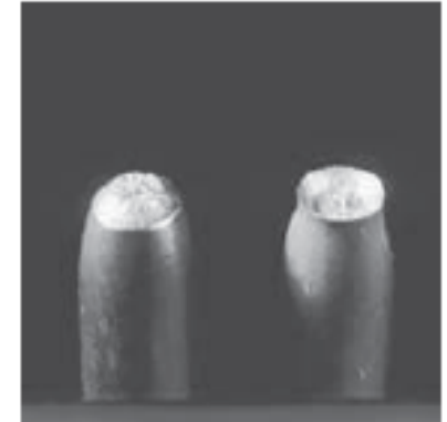
En esta probeta de acero se observa con claridad la estricción que ocurre justo antes de su falla. Lo anterior ocasiona una fractura típica de "copa y cono", la cual es característica de los materiales dúctiles.
