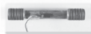
Probeta de acero típica con un medidor (galga) de deformación cementado.
