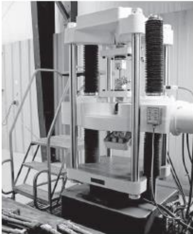
Fotografía 2.2 Esta máquina se emplea para realizar pruebas a tensión en probeta, como las que se explican en este capítulo.
