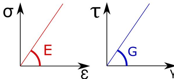
Fig. 1.9: Representación de la Ley de Hooke uniaxial
