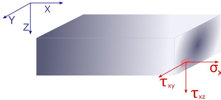
Fig. 1.7: Tensiones en X, Y, Z
