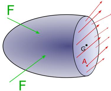
Fig. 1.3: Fuerzas distribuidas en la superficie de la sección
