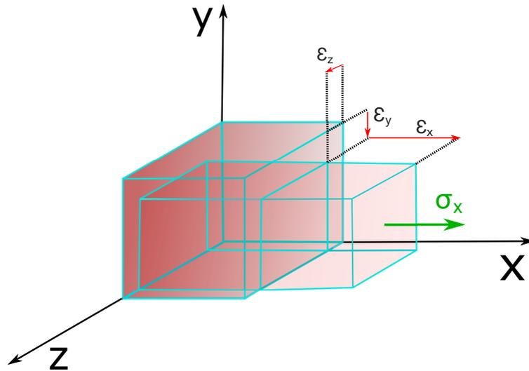
Fig. 1.8: Deformación ante carga uniaxial
