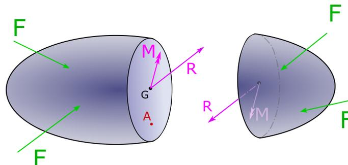
Fig. 1.2: Corte por un plano  $\pi$
