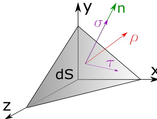
Fig. 1.6: Descomposición en normal y tangencial
