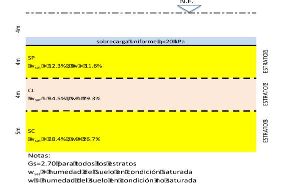
9- Para la excavación sostenida con tablestacas metálicas se pide:
