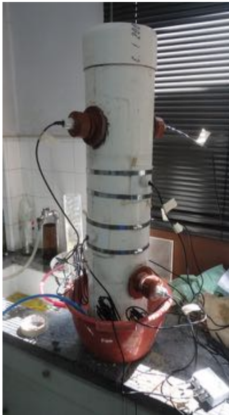
Columna de infiltración
