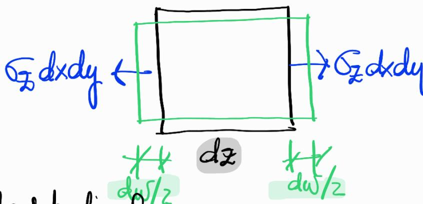
$\epsilon$  = Deformación específica longitudinal
