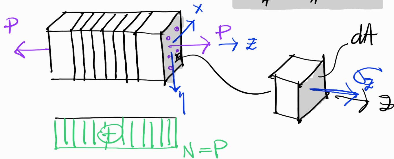
Hipótesis de Secciones Planas y paralelas luego de la deformación.
