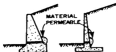
c) Drenes continuos: Se utiliza un dren horizontal que une las entradas de los tubos de salida y que se descargan lateralmente afuera del muro. A veces se complementa con un sistema de drenes verticales adosados al respaldo del muro.
