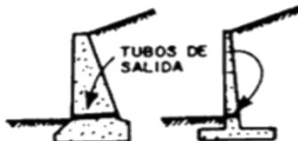
b) Tubos de salida con bolsones de material permeable: No se podrá usar cuando el relleno tenga finos susceptibles de contaminar el material permeable, y en general, sólo será conveniente en rellenos en que el agua pueda movilizarse hacia el material permeable y hacia los tubos de salida.
