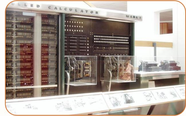
**Mark I**, fue el primer ordenador electromecánico, construido en IBM y enviado a Harvard en 1944. Tenía 760.000 ruedas y 800 kilómetros de cable y se basaba en la máquina analítica de Charles Babbage. El computador empleaba señales electromagnéticas para mover las partes mecánicas. Funcionaba con relés, se programaba con interruptores y leía los datos de cintas de papel perforado.
