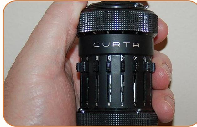
**Curta** (inventada por Curt Herzstark) fue una calculadora mecánica introducida en 1948 en Liechtenstein. Era pequeña y tenía una manivela para ser operada. Podía ser usada para realizar operaciones de adición, sustracción, multiplicación, división, y, con más dificultad, raíces cuadradas y otras operaciones. El diseño de Curta fue una variante del aritmómetro de Leibniz, acumulando valores en ruedas dentadas, que eran sumados o complementados por un mecanismo de tambor de paso.
