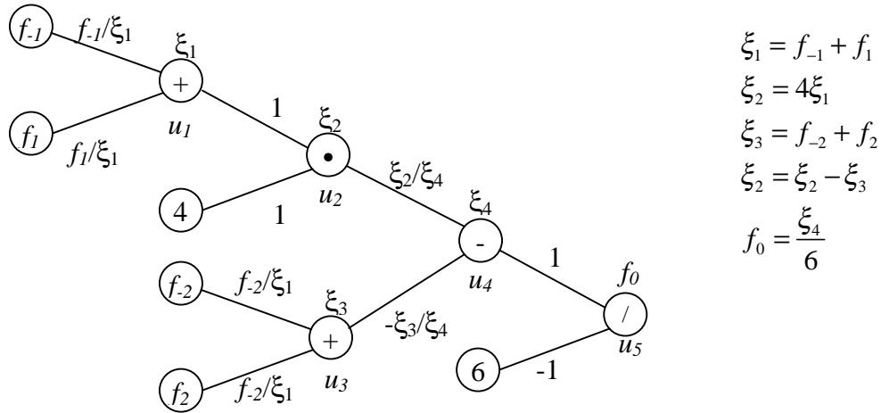
$$r_{f_0} = \left( \frac{f_{-1}}{\xi_1} \cdot r_{-1} + \frac{f_1}{\xi_1} \cdot r_1 + u_1 + u_2 \right) \frac{\xi_2}{\xi_4} - \left( \frac{f_{-2}}{\xi_3} \cdot r_{-2} + \frac{f_2}{\xi_3} \cdot r_2 + u_3 \right) \frac{\xi_3}{\xi_4} + u_4 + u_5$$
