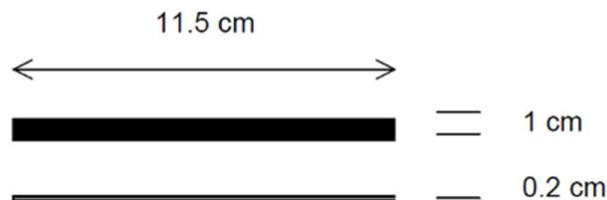
Figura 2 - Dimensiones de los elementos palitos de helado
