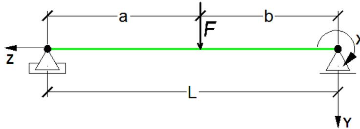
Siguiendo el análisis efectuado en el **Ejemplo N°1** se indica a continuación el diagrama de cuerpo libre con las secciones transversales de interés:
