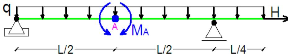
A continuación se indica el mecanismo de un grado de libertad al que se le aplica el desplazamiento virtual (DV):
