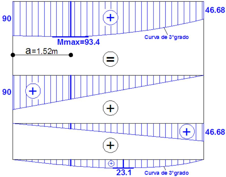
**Diagrama de esfuerzo de corte (Kn).**
