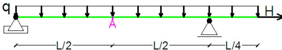
Para la estructura precedente se determinará **MA**, **QA** y **NA** por aplicación del principio de los trabajos virtuales.
