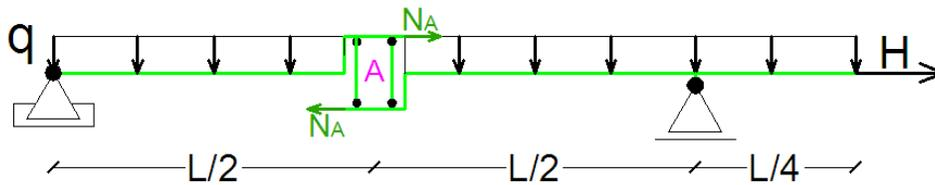
A continuación se indica el mecanismo de un grado de libertad al que se le aplica el desplazamiento virtual (**DV**):
