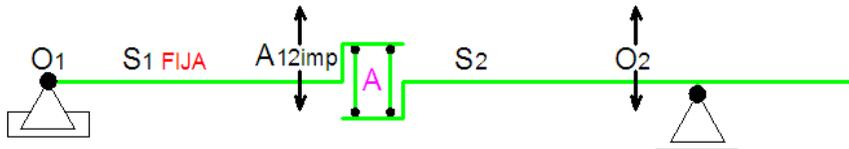
Obsérvese que la articulación relativa entre chapas coincide con el punto fijo de la chapa **S2**. Por lo tanto la chapa **S1** con dos puntos fijos ( **$O_1$**  y  **$A_{12imp}$** ) se encuentra fija.
