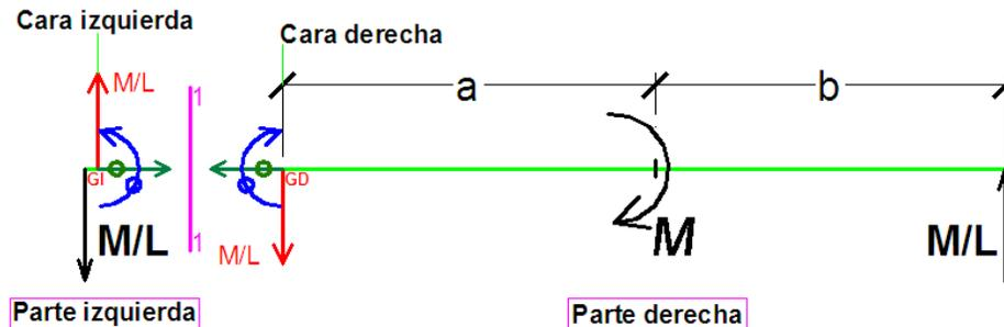
Si bien la estructura en su conjunto se encuentra solicitada por un sistema de fuerzas en equilibrio, al cortar la misma en la sección 1, los sistemas que actúan en ambas partes (parte izquierda y parte derecha) quedan desequilibrados.
