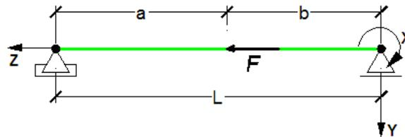
Se indica a continuación el diagrama de cuerpo libre con las secciones transversales de interés:
