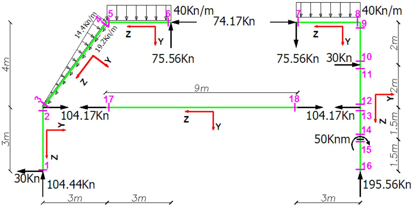
De acuerdo al procedimiento conocido (determinación de los [esfuerzos característicos](#) en [secciones transversales de interés](#) y aplicación de las [relaciones diferenciales](#)) se trazan a continuación los [diagramas de características](#).
