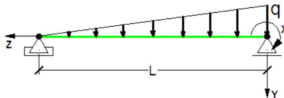
Se indica a continuación el diagrama de cuerpo libre con las secciones transversales de interés:
