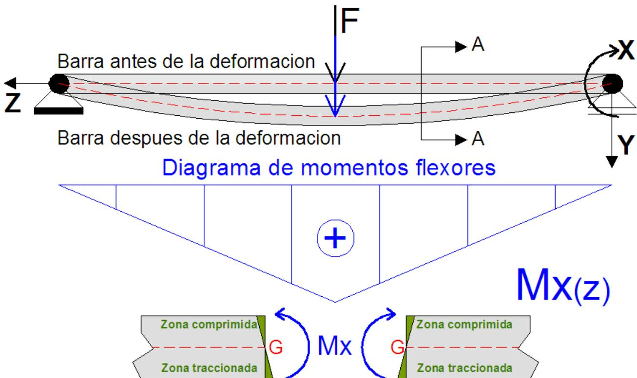
Puede observar el lector que, para el caso graficado, [las fibras inferiores tienden a alargarse](#) (desde el punto estático [se traccionan](#)) y [las fibras superiores tienden a acortarse](#) (desde el punto de vista estático [se comprimen](#)).
