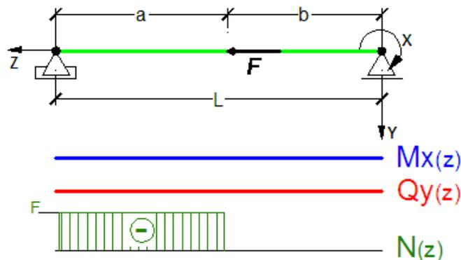
Considerando que la fuerza distribuida de dirección coincidente con el eje de barra ( $q_z(z)$ ) vale cero, entonces la función esfuerzo normal es constante.
