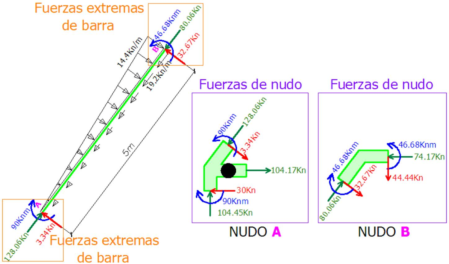
Las **fuerzas extremas de barra** se determinan leyendo los diagramas de características previamente trazados y las **fuerzas de nudo** haciendo uso del principio de acción y reacción.
