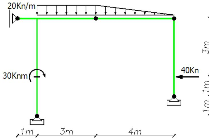
Se indica a continuación el [diagrama de cuerpo libre](#), las [secciones transversales de interés](#) y las [ternas locales](#).
