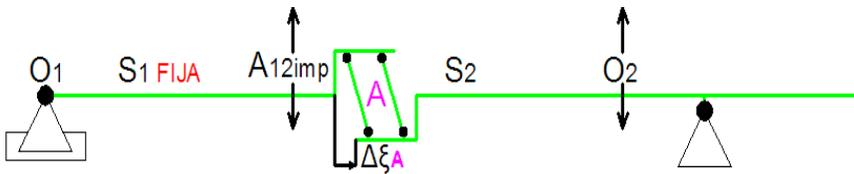
Aplicando la ecuación del principio de los trabajos virtuales resulta:
