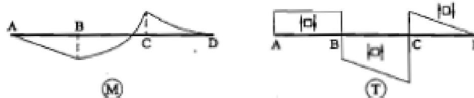
Fig. 5.16: Diagramas de esfuerzo cortante y momento flector para el ejemplo 8.
