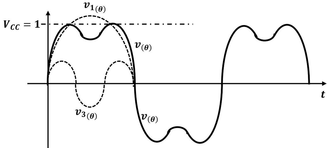
**Fig. 1: Forma de onda de la moduladora conteniendo tercera armónica**
