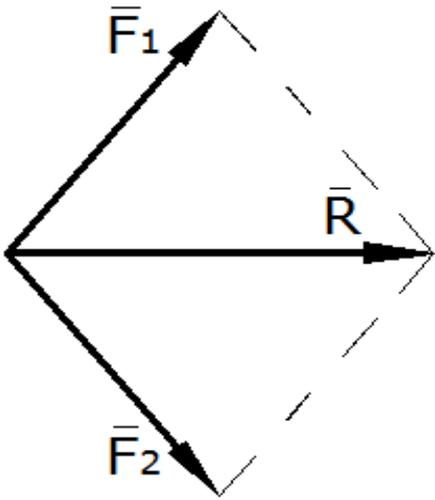
• **Regla del paralelogramo:** El efecto de 2 fuerzas,  $F_1$  y  $F_2$ , aplicadas en un mismo punto de un cuerpo rígido, es equivalente al de una única fuerza llamada Resultante (aplicada en el mismo punto), y cuya intensidad y dirección quedan definidas por la diagonal del paralelogramo que tiene por lados los vectores representativos de las fuerzas componentes.
