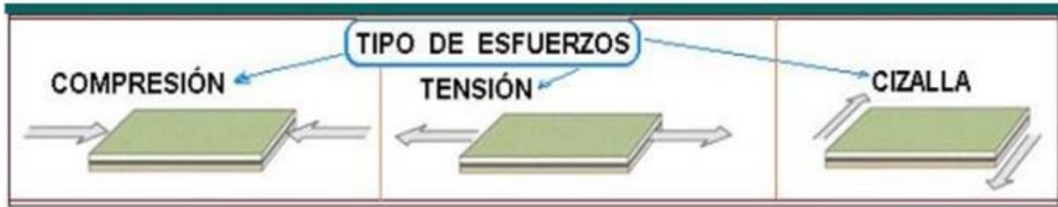
Estructuras resultantes de cada tipo de esfuerzos
