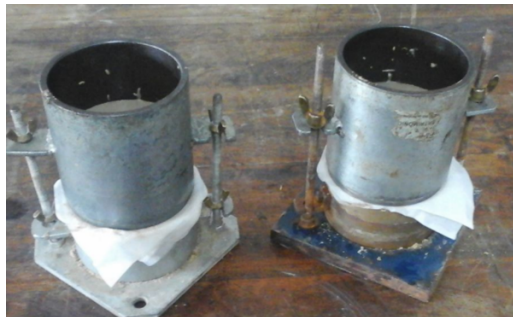
Figura A.4: Colocación de slurry en el molde.
