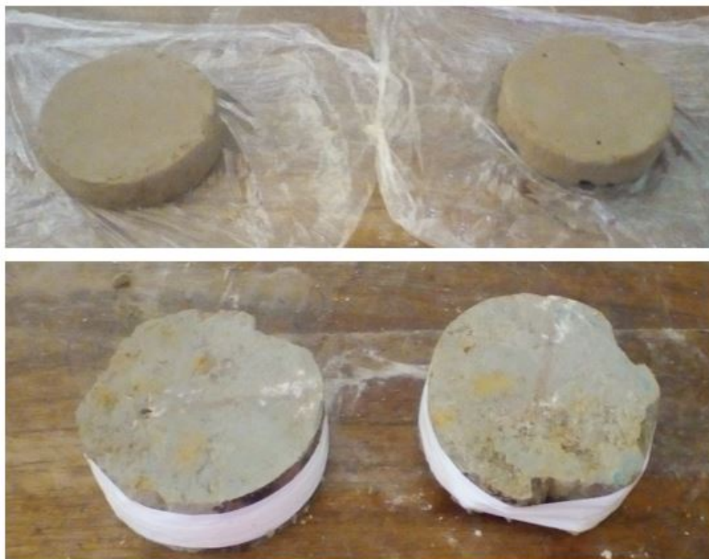
Figura 4.15: Muestras de succión del suelo desestructurado (arriba) y estructurado (abajo).
