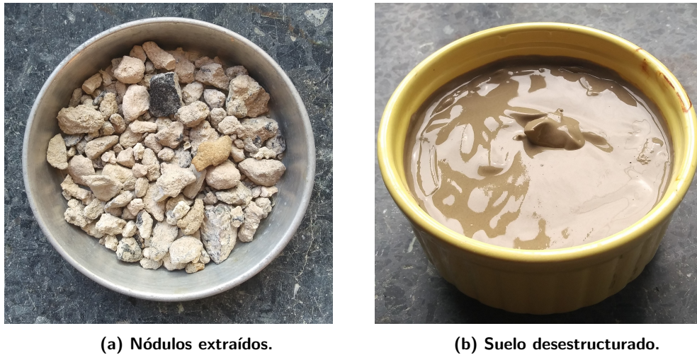
Figura 4.5: Suelo desestructurado y separado de los nódulos cementados.
