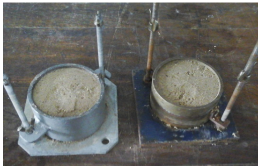
Figura A.2: Arena compactada en el collar del molde proctor.
