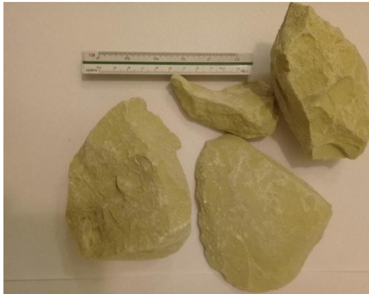
Fig. 3.41: Bloques de arcilla natural con características de roca blanda.
