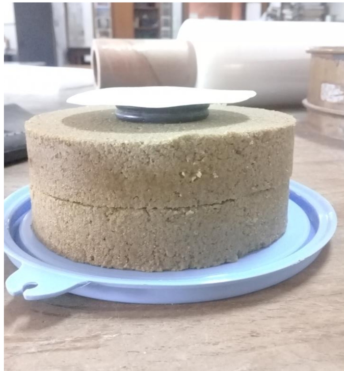
Fig. 3.47: Muestra en preparación. Se observan las dos pastillas de suelo y el papel filtro superior separado por un o-ring.
