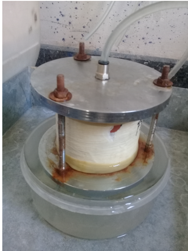
Fig. 3.50: Permeámetro durante ensayo. Pared confeccionada con tubo de PVC. El nivel de restitución constante se asegura por desborde.
