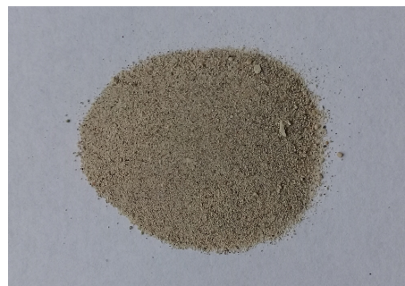
Fig. 1.84: Suelo retenido en el tamiz #200
